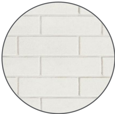
BRIQUE BRAMPTON FORMAT PREMIER PLUS 257X79X90 COULEUR POLAR WHITE OU ÉQUIV. FINI LISSE, STANDARD POSE PANERESSE ET SOLDAT
